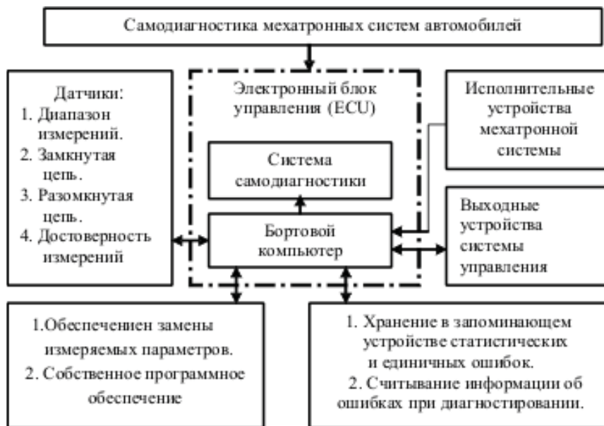
Рис. 2. Структурная схема самодиагностики мехатронных систем автомобилей
