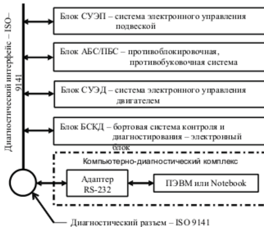
Рис. 4. Структурная схема компьютерной диагностики мехатронных систем автомобиля МАЗ с двигателем MAN D2866-LF20
