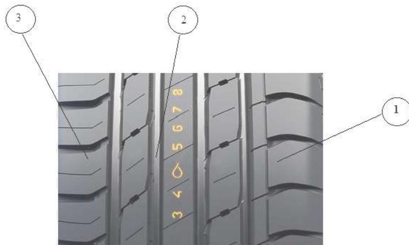
Рис. 1. Фрагмент шини ContiPremiumContact з різними функціональними зонами
