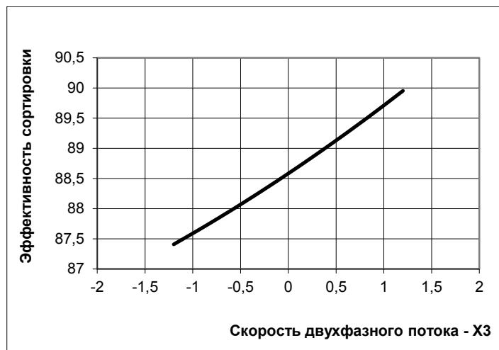
Рис. 7. Зависимость эффективности сортировки от скорости двухфазного потока
