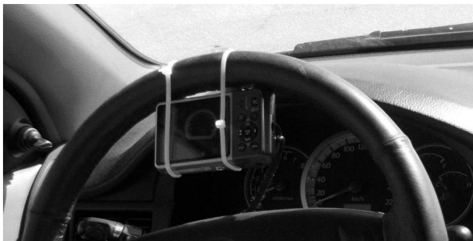
**Рис.7. Устройство видеофиксации на рулевом колесе**
