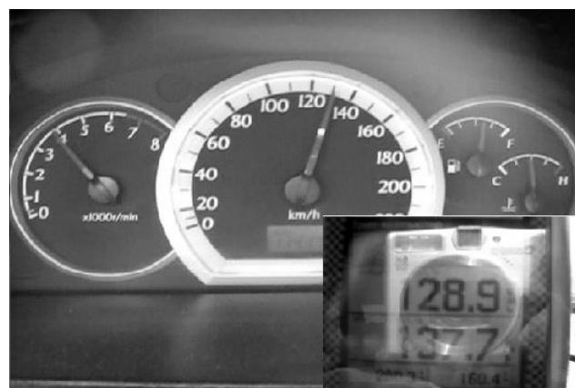
Рис.6. Градуировка спидометра с помощью GPS навигатора
