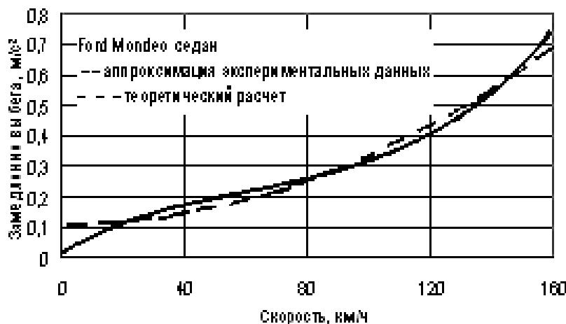
Рис. 1. Зависимость замедления выбега автомобиля от скорости [2]
