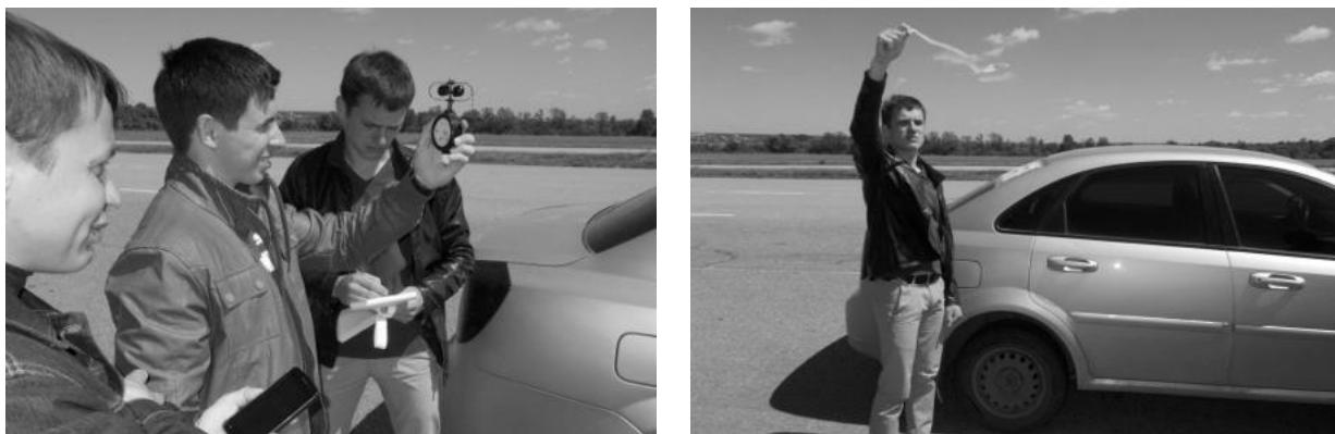
Рис.5. Определение направления и скорости ветра
