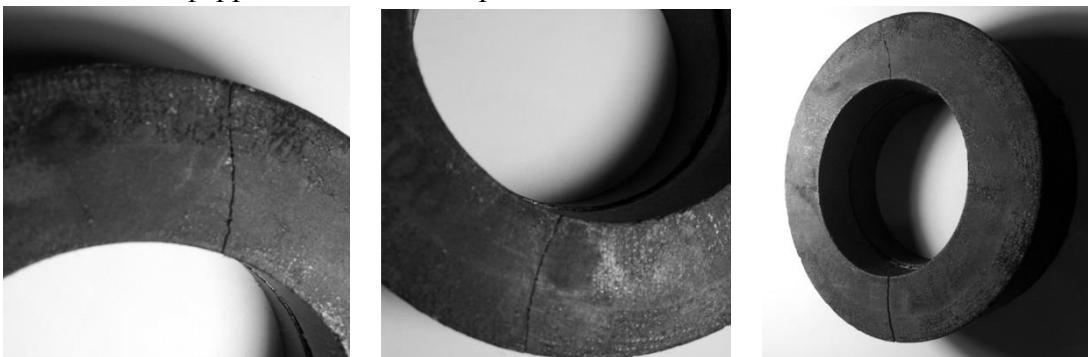
**Рис. 2. Ферритный тороидальный магнитопровод, разрушенный магнитострикционным эффектом**
