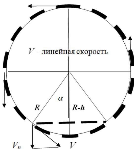
**Рис. 2. Схема взаимодействия узоров протектора с полотном дороги**
