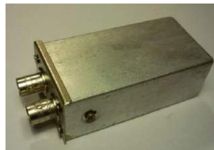
Рис.3. Вид источника колебаний со смещенным центром масс и с закрепленными датчиками а) - 18.3855; б) - Д14.507
