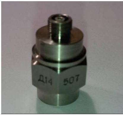
Рисунок 1 – Датчик ускорения (акселерометр) Д14.507 и его характеристики
