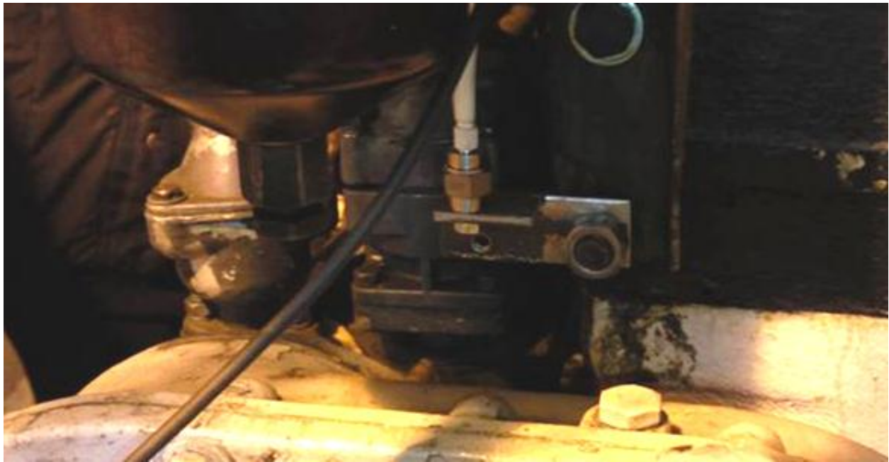
Рисунок 2 – Крепление вибродатчика на головке блока цилиндров дизельного ДВС К461М1
