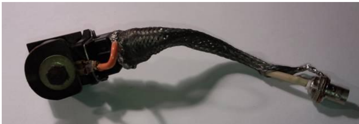
Рисунок 10 – Внешний вид вибродатчика 18.3855 и его характеристики
