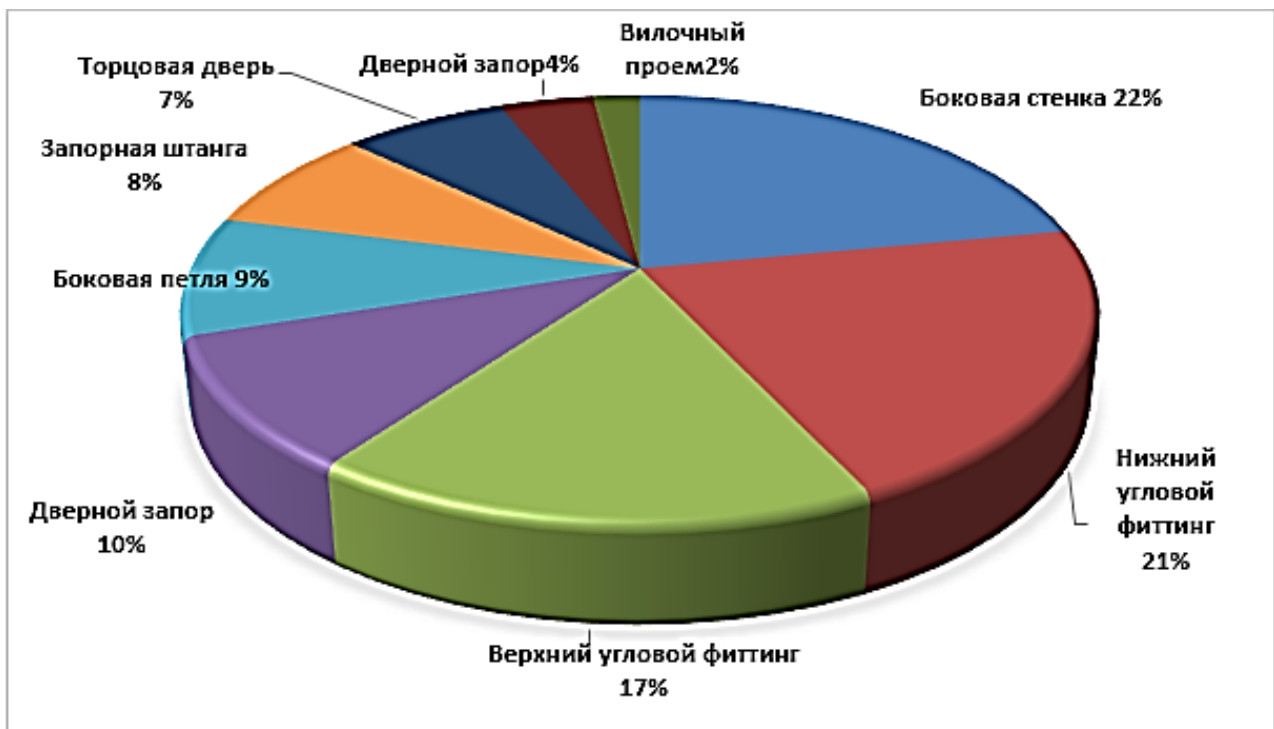
Рис.2 – Анализ дефектов и неисправностей элементов конструкции контейнера
