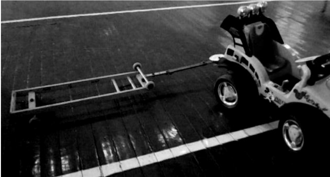
Рисунок 4 - Физическая модель классического двухзвенного автопоезда
