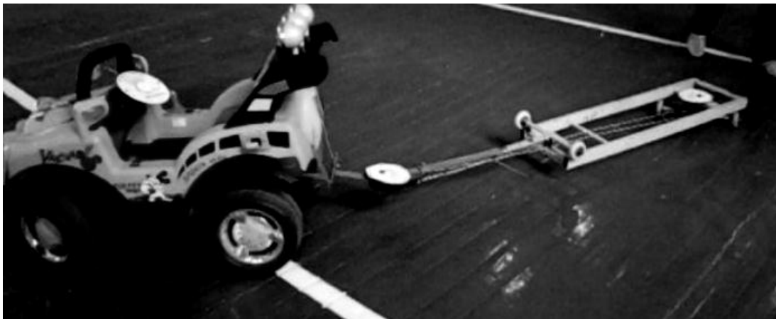
Рисунок 7 – Физическая модель седельного автопоезда с управляемым полуприцепом.
