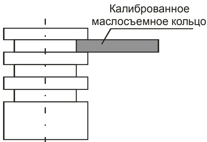
Рис. 4. Проверка посадки кольца в канавке с помощью эталонного кольца
